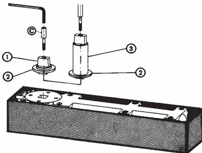
Выверните винт **C** при помощи шестигранного ключа (5 мм) и снимите стандартную шпindelную вставку. Переставьте грязезащитную шайбу на удлиненную шпindelную вставку. Установите шпindelную вставку в доводчик и закрепите винтом **C**. Проверьте чтобы винт **C** был надежно затянут.
