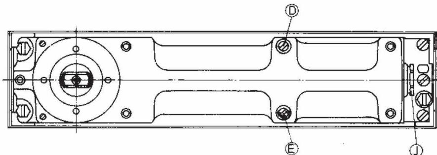
Для регулировки скорости закрывания в диапазоне  $80^{\circ}$ – $0^{\circ}$  используйте клапан **D**. Регулировочный клапан **E** выполняет три функции:
