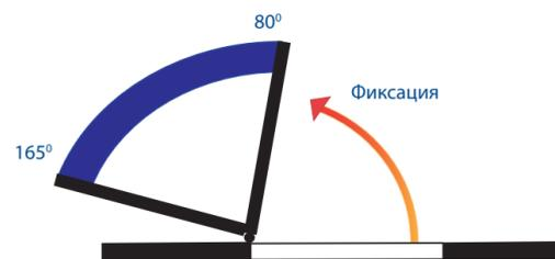
**Совет:** Если Вы хотите произвести не полную фиксацию положения створки, а только обеспечить задержку закрывания – например, для большего удобства погрузки и разгрузки транспорта или для облегчения прохода в больницах, – эта функция может быть легко активирована альтернативно фиксации обычным переключением клапана!
